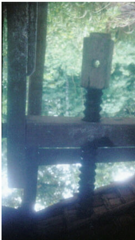
Figura 15 – Rosca de Ipê ( Tabebuia serratifolia ), talhada artesanalmente, como componente de uma prensa utilizada para prensagem da mandioca em uma casa de farinha na Comunidade Jericó, Garrafão do Norte, Pará.
